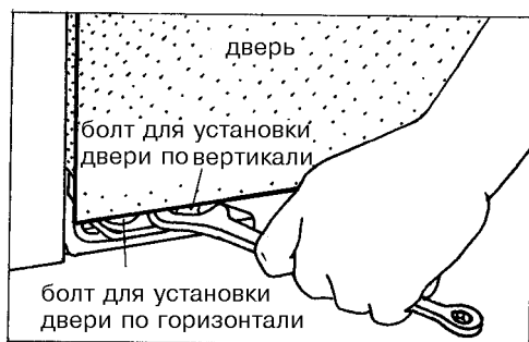
Рис. 142. Регулировка положения двери
